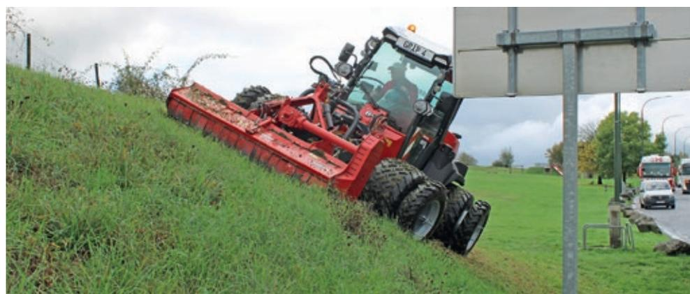
Grip 4-70 en action pour l'entretien des talus. Combinaison avec un broyeur frontal SAUERBURGER- Tango 2150 et un broyeur latéral arrière SAUERBURGER Orbit 1800.
