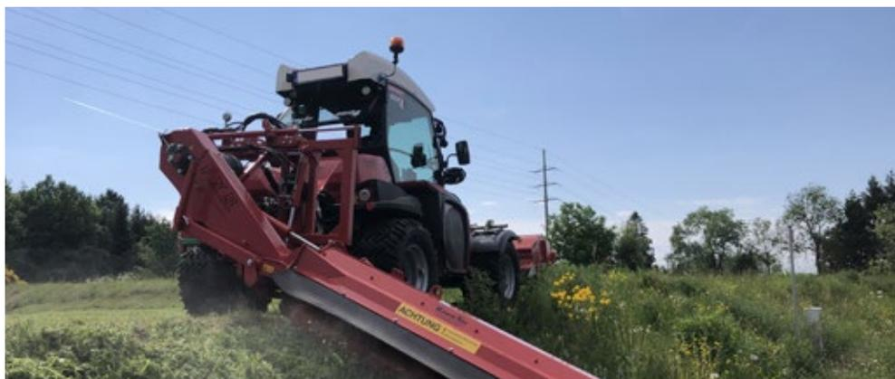
Pour les communes et les exploitants de terrains de loisirs, le Grip 4-70 se distingue par sa simplicité, sa robustesse et son faible encombrement. Équipé de pneus larges pour le gazon, la pression au sol est réduite de telle sorte qu'il est possible de circuler sur les terrains enherbés et pelouses sans problème. Grâce aux quatre roues directrices, il est possible de contourner facilement les obstacles.
