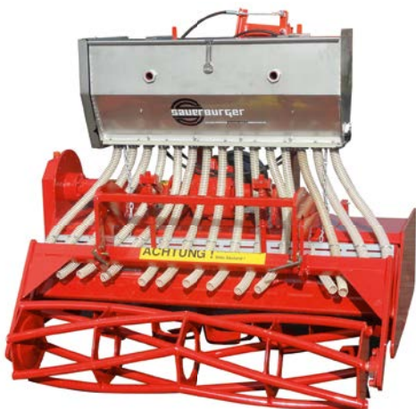
PANDA 1400S mit Drillmaschine und Rohrtragwalze
