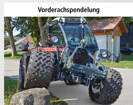
Das Pendelgelenk verleiht dem Fahrzeug eine hohe Kippstabilität. Die Position des Pendelgelenks ermöglicht der Vorderachse einen extrem großen Pendelweg
