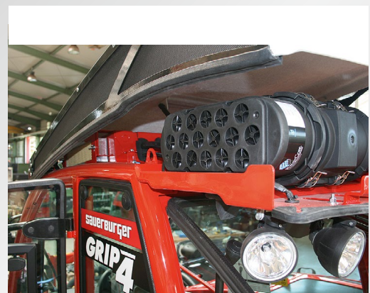
Durch Hochklappen des Kabinendaches sind die Luftfilterelemente zur Wartung und Reinigung einfach zugänglich
