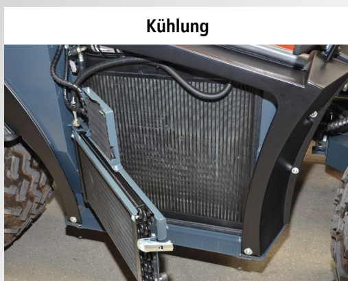
Seitlich angeordnetes Kühlerpaket ermöglicht die einfache Reinigung durch werkzeugloses Wegschwenken der einzelnen Kühlersegmente. Optional: reversierbarer Lüfter
