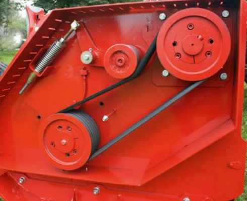
Keilriemenantrieb mit automatischer Spannvorrichtung
