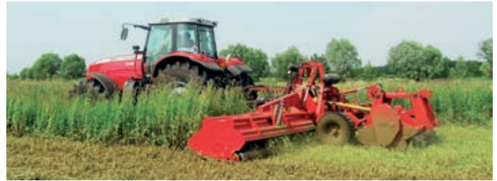
Version traînée, complète sur châssis porteur
